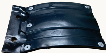
Sapata em aço Montada
